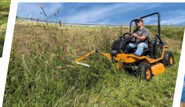
Insektenschonendes Mähen mit Scheuchvorrichtung
