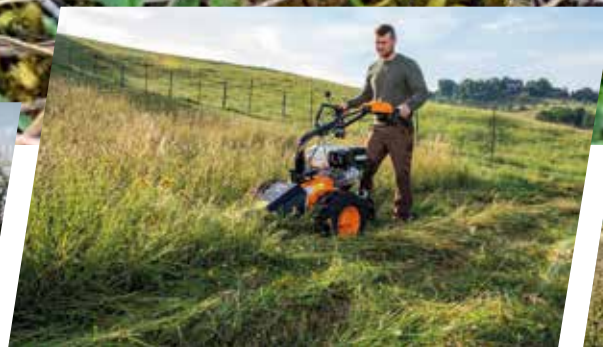
Schonender Schnitt mit Doppelmesser-Mähbalken
